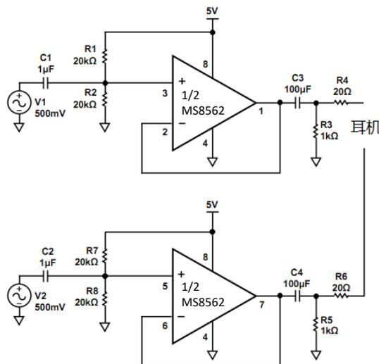
图中，R1 和 R2 将输入电压偏置为电源电压的一半，使信号的带宽范围最大化。C1 和 C2 用来 ac 耦合输入信号。C1, R1, R2 组成一个高通滤波器，他的拐点频率为  $1/[2\pi(R1||R2)C1]$ 。MS8562 的高输出可以驱动大电阻负载。
