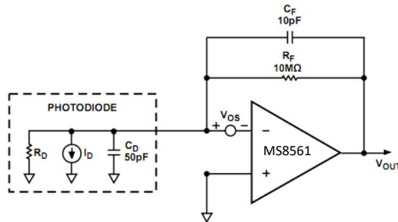
放大器的输入偏置电流会产生一个与  $R_F$  成比例的误差项，失调电压由于分流电阻  $R_D$  的关系会引起暗电流，这些误差项将在放大器的输出端体现，误差电压的公式如下：
