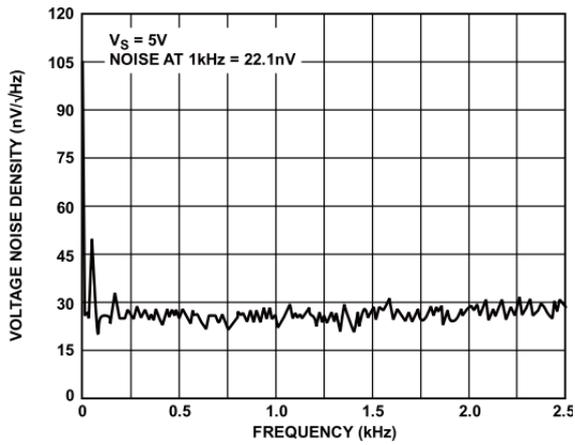
5V 时，0Hz 到 2.5kHz 电压噪声密度
