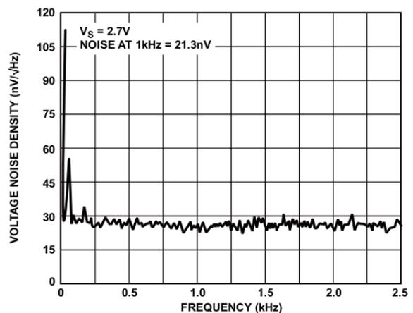
2.7V 时, 0Hz 到 2.5kHz 电压噪声密度
