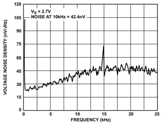
2.7V 时，0Hz 到 25kHz 电压噪声密度
