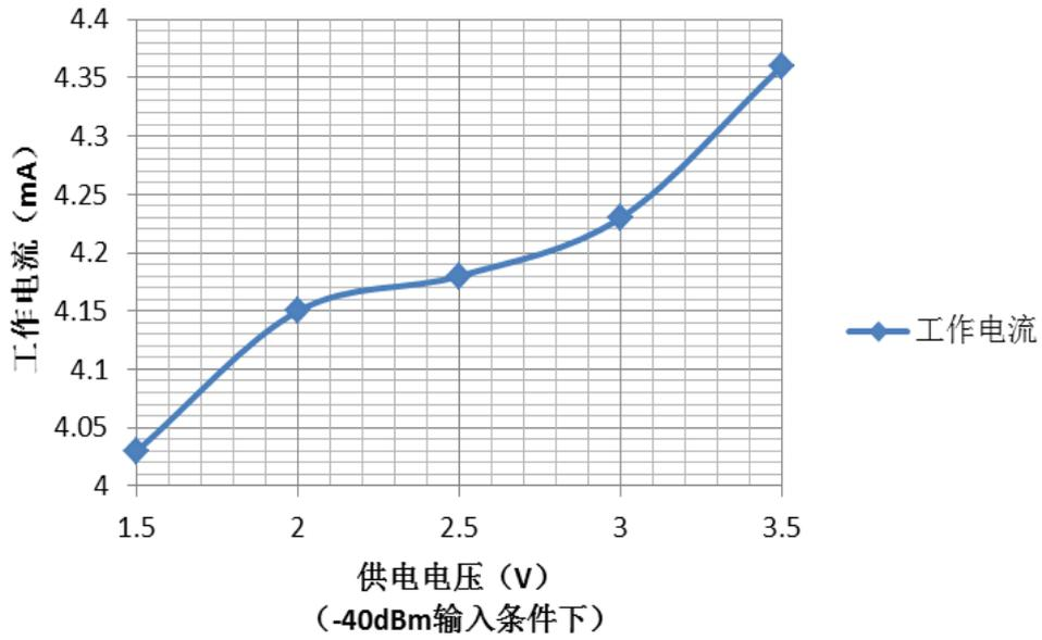
图 3. 工作电流 vs. 供电电压
