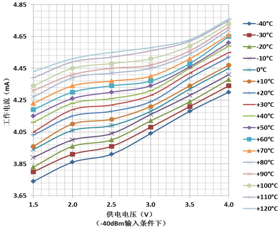
图 5. 不同环境温度下，工作电流 vs. 供电电压
