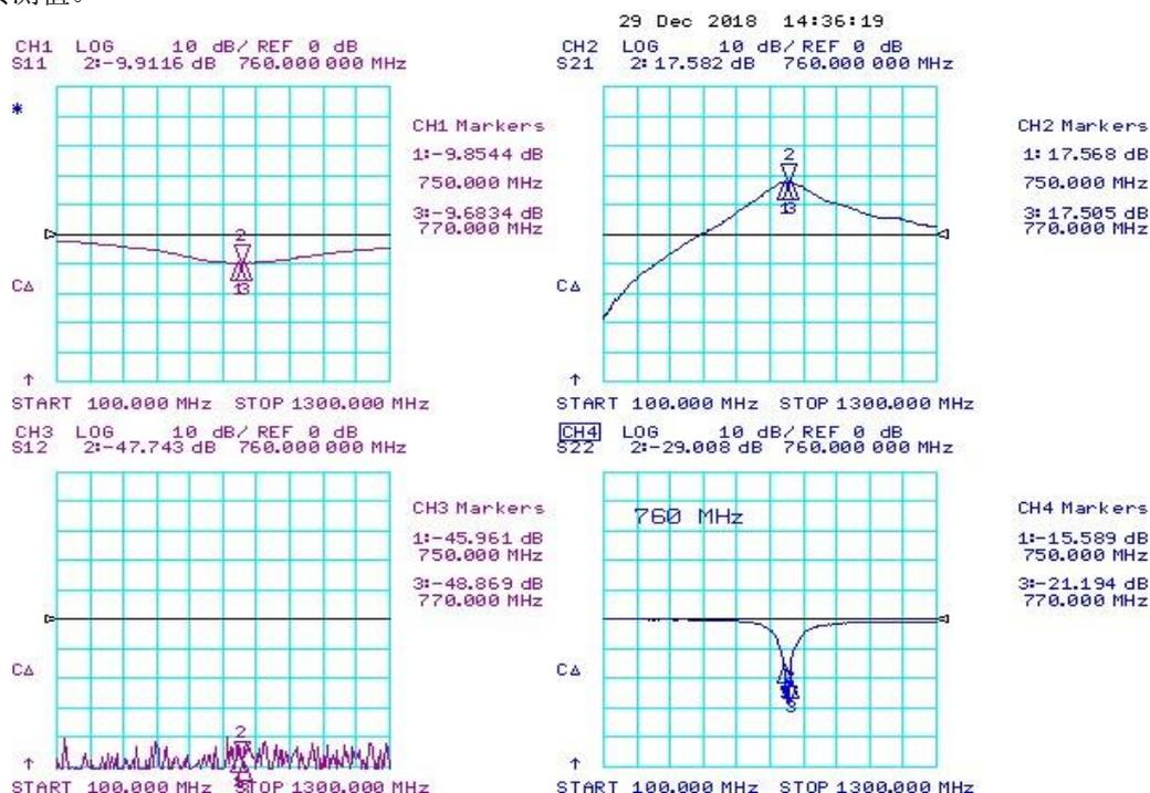
下图为供电电压3V，输入匹配电感L1=2.7nH条件下，北斗二代、GPS和Glonass三种导航模式下的噪声系数和相应增益实测值。
