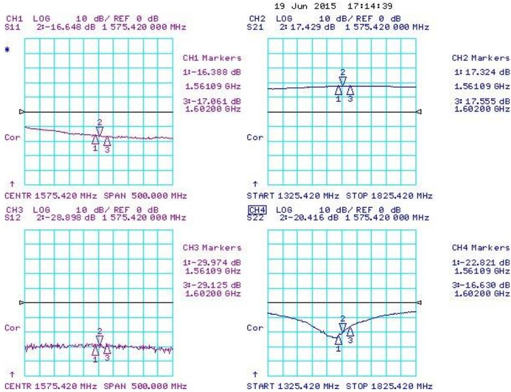
下图为供电电压3V条件下，北斗二代、GPS和Glonass三种导航模式下的噪声系数和相应增益实测值。
