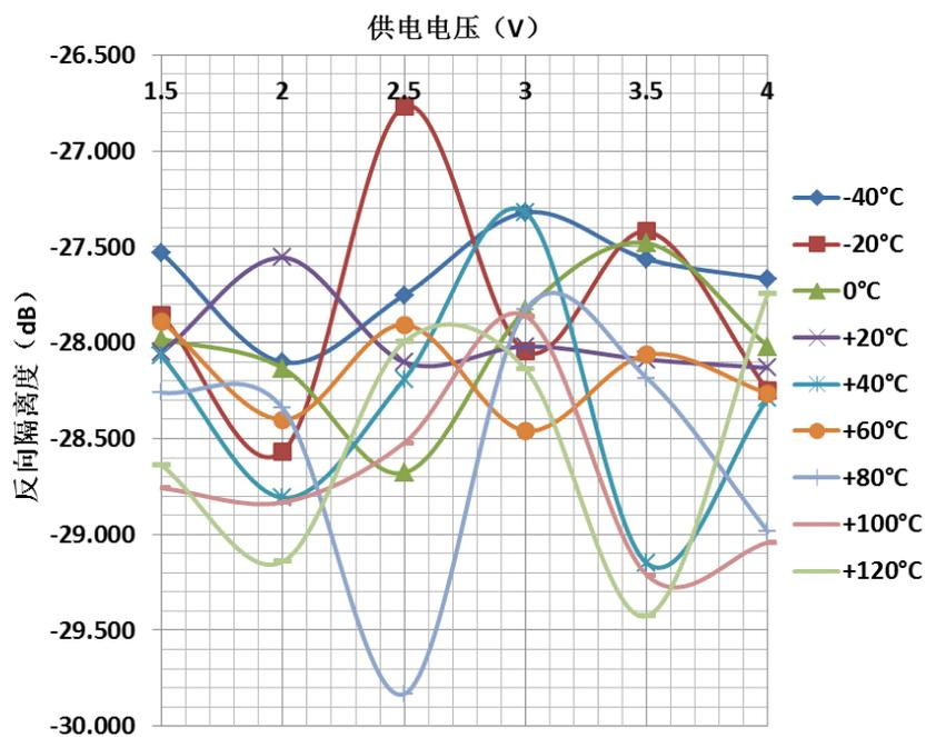
图 20. 反向隔离度|S12|与供电电压及环境温度的关系曲线 (Glonass 模式)
