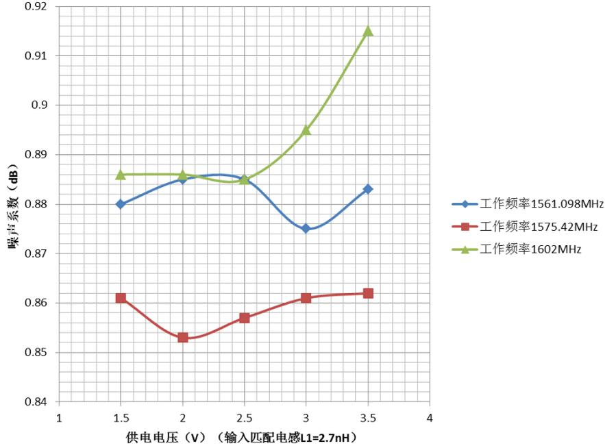
图 1. 噪声系数 VS. 供电电压
