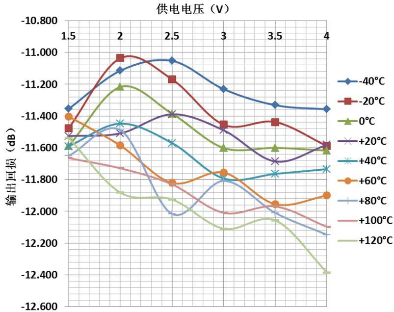
图 19. 输出回损与供电电压及环境温度的关系曲线 (Glonass 模式)
