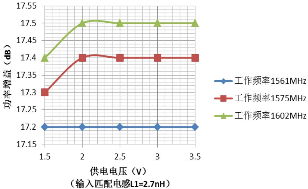
图 2. 功率增益 VS. 供电电压
