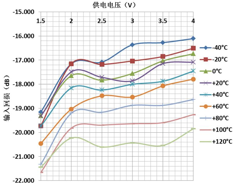
图 18. 输入回损与供电电压及环境温度的关系曲线 (Glonass 模式)
