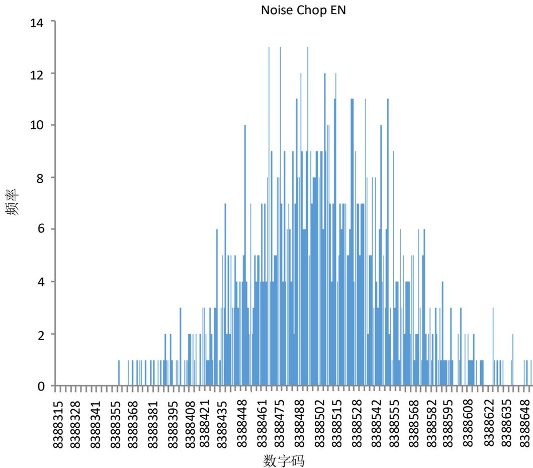
MS5194T 噪声分布柱状图 (AVDD=4V, 内部基准, 增益 = 64, 更新速率 = 16.7 Hz, 斩波使能)
